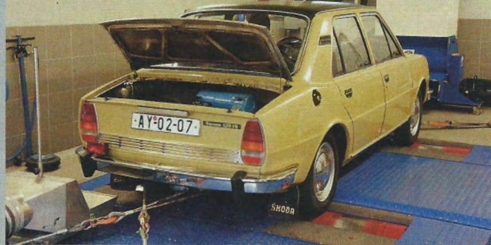
Na válcové zkušební přísada přidala 0,8 kW ve špičce, v jiných režimech však i celé 2 kW
